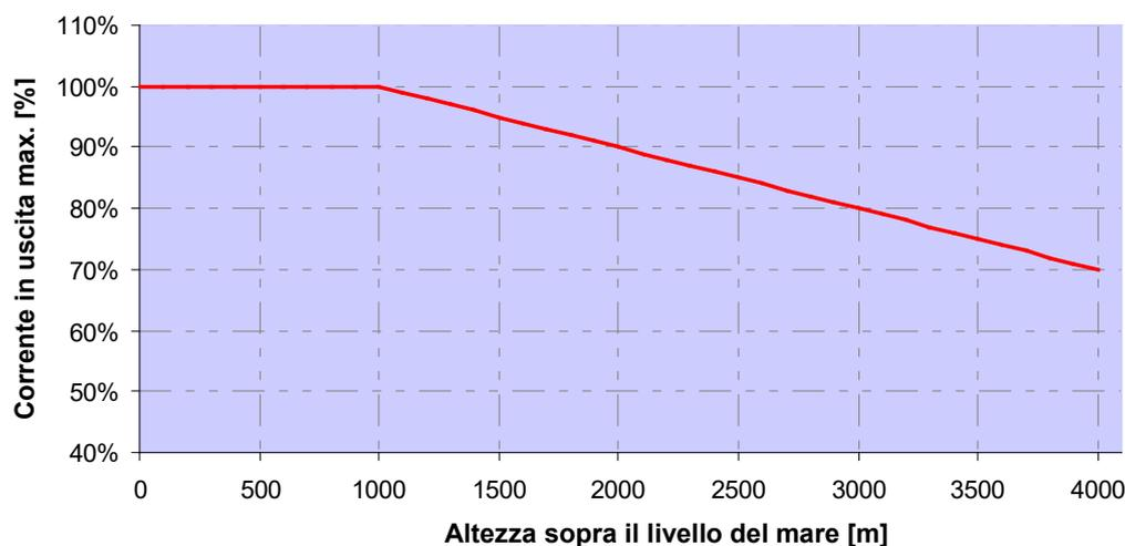
Fig. 53: Derating della corrente massima in uscita in funzione dell'altitudine di installazione
