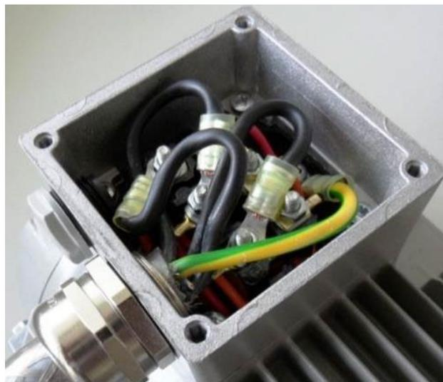
Fig. 31: Cablaggio nella scatola morsettiera del motore
