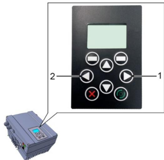
Se la comunicazione con l'INVERTERpc Tool avviene entro 25 sec., l'"opzione MMI" rimane in modalità Standby. A questo punto è possibile lo scambio dati con il PC e/o con un MMI esterno.
