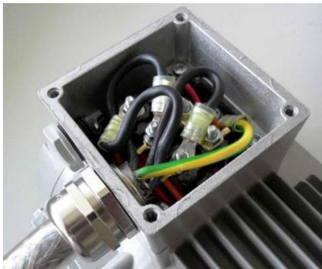
Fig. 23: Cablaggio nella cassetta di connessione motore
