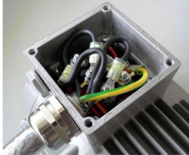
Fig. 27: Cablaggio nella cassetta di connessione motore
