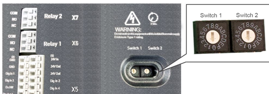
Abb.: 10 Parametereinstellung über Drehschalter
